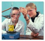
Figure 3 Quickfit apparatus for reflux.
